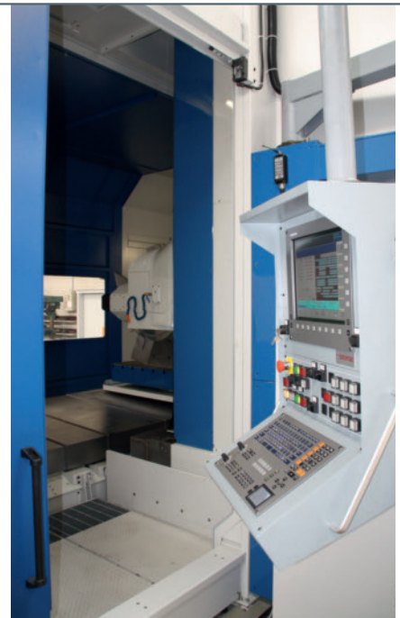
5 Zweites Bedienpanel auf der Rückseite: Bei der Vollausrüstung der TRT 314 HS kamen den HSR-Mitarbeitern die zahlreichen Konfigurationsmöglichkeiten des Grundkonzepts entgegen
